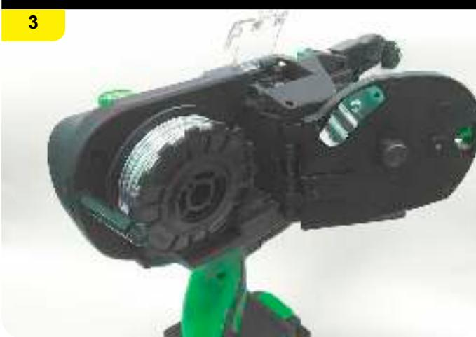
Insérez la pointe du fil dans le guide-fil, à travers l'écartement des engrenages d'alimentation jusqu'au chemin dans le bras de la mâchoire supérieure de la machine A (max. 70mm).
