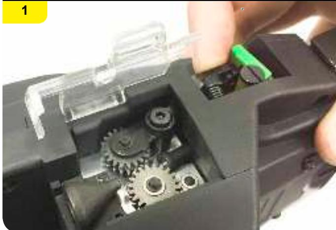
Desenclave el pestillo para abrir la puerta y cargar el rollo de alambre.
