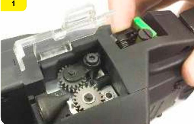
Déverrouiller le bouchon du moulinet pour ouvrir la porte en arrière et charger la bobine de fil.
