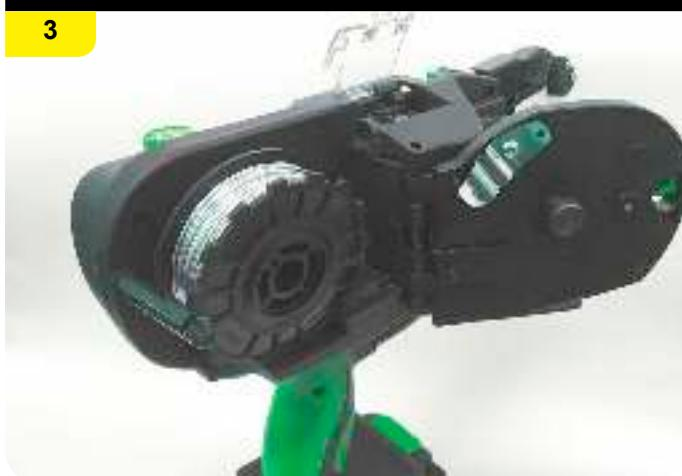
Introduzca el extremo del alambre por el embudo y hágalo pasar a través de las coronas hasta introducirlo en el conducto.
