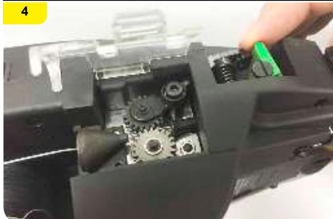
Poussez le bouchon de déverrouillage pour déverrouiller le levier, assurez-vous que le levier est de retour à la position d'origine et que les engrenages d'alimentation serrent le fil
