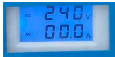
N'appuyez pas sur START si la tension indiquée sur le voltmètre n'est pas dans les limites prescrites. Si la tension du réseau dépasse ces limites, elle provoque des dommages irréversibles au système électrique.
