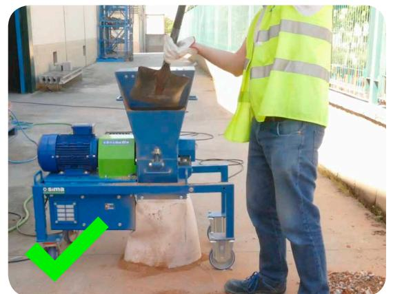
No desconecte la máquina si no ha terminado de triturar a menos que sea una emergencia. Si desconecta la máquina con restos de escombro en el interior de la cámara de trituración, el motor no tendrá potencia suficiente para volver a ponerse en marcha.
