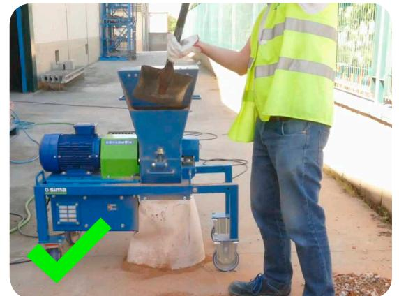
Ne débranchez pas la machine si vous n'avez pas fini de broyer sauf en cas d'urgence. Si vous débranchez la machine avec des débris à l'intérieur de la chambre de concassage, le moteur n'aura pas assez de puissance pour redémarrer.
