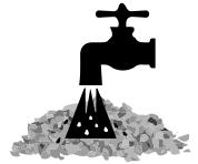
Humedezca el escombro con una manguera antes de ser triturado. Las emisiones de polvo se verán reducidas hasta en un 80%. No humedezca en exceso, se generarán lodos dentro de la tolva y cámara de trituración. Realice también una prueba de triturado sin humedecer para comparar resultados y adquirir más experiencia.
