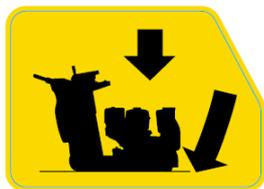
DESCENTE DE LA MACHINE LORSQUE LE VOLANT TOURNE DANS LE SENS DES AIGUILLES D'UNE MONTRE.
