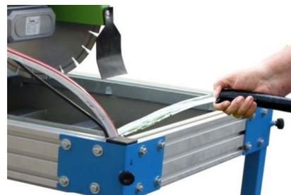
Pendant les opérations de coupe, beaucoup d'impuretés s'accumulent dans le fond du bac. Il faut alors fréquemment changer l'eau dans le but de garantir le bon fonctionnement de la pompe et un refroidissement optimal du disque. Le bac est doté d'un bouchon de vidange qui facilite cette tâche.
