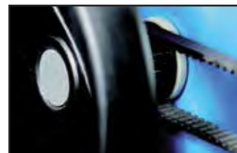
Avance de la coupe par courroie de transmission dentée.
