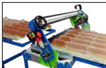
Modèle spécialement adapté pour la découpe de panneaux sandwich.
