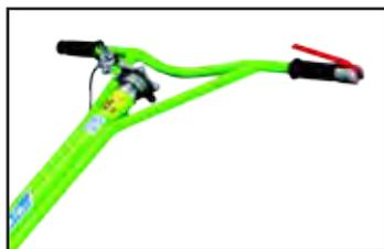
Réglage de l'inclinaison des pâles par volant lobulaire ergonomique et câble en acier.
