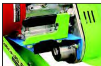
Poignée avant pour un levage manuel.
