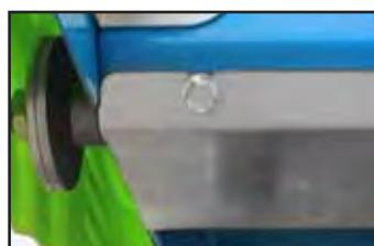
Carter de protection des roulements et arbre du disque.
