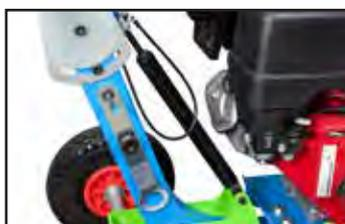
Système de levage par amortisseur à gaz.
