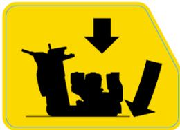
LENKRAD IN UHRZEIGERSINN DREHEN, SINKT DIE MASCHINE.
