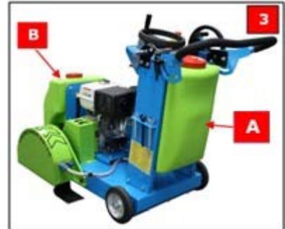
Jeder Tank besitzt ein Absperrventil (**A, Bild 4**) um den Wasserzufuhr zu unterbrechen.
