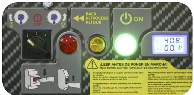
**Position 0.** Maschine ausgeschaltet
