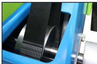
Übertragung: POLY-V Antriebsriemen für bessere Haftung.
