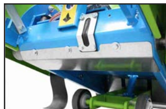
untere Schutzeinrichtung für: Lager, Antriebswelle und Übertragung.
