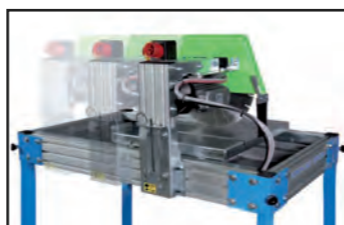
verschiebbarer Schneidekopf für höhere Effizienz bei kleinen Schnitten.
