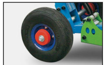
pannensichere Hinterräder, schlauchlos mit grossen Ø (260 mm).
