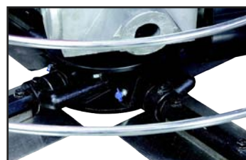
Glättflügel mit Schmiernippel ausgestattet für eine bessere Wartung.
