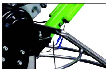
abnehmbare Lenkstang mit 3-Rohr-Struktur, elektr. Kabeln & Gashebel.
