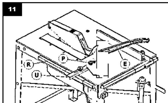
Pour obtenir l'angle souhaité, il faut desserrer la molette de serrage de la pièce d'appui **P, Fig.11** et la faire pivoter sur la position désirée.
