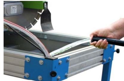
Durante las operaciones de corte se acumula gran cantidad de suciedad en la bandeja por lo que habrá que cambiar el agua las veces que sea necesario para garantizar el buen funcionamiento de la bomba y la perfecta refrigeración del disco; la bandeja incorpora un tapón de vaciado que facilita esta operación.
