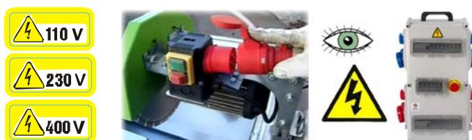
Una vez haya realizado el paso anterior es necesario comprobar el sentido de giro del motor como indica la flecha del resguardo del disco. Ponga en marcha la máquina observando la dirección de giro. En el caso de no girar en el sentido marcado por la flecha, puede cambiar el sentido de giro intercambiando entre sí dos hilos conductores de fase en la base aérea o en la clavija del cable de extensión que se vaya a alimentar la maquina,
