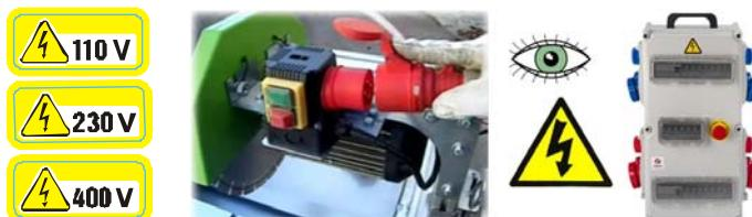
Ensuite, il faut vérifier le sens de rotation du moteur comme l'indique la flèche qui se trouve sur le carter du disque. Pour cela il est nécessaire de brancher la machine au réseau et de la mettre en marche tout en observant le sens de rotation du moteur marqué par la flèche. On peut changer éventuellement le sens de rotation en changeant 2 fils sur la base aérienne ou sur le câble d'alimentation de la machine.
