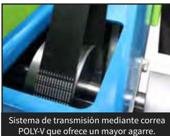
Sistema de transmisión mediante correa POLY-V que ofrece un mayor agarre.
