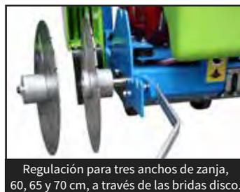
Regulación para tres anchos de zanja, 60, 65 y 70 cm, a través de las bridas disco.
