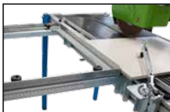
Juego de escuadra y pisadores para fijar la posición del material (opcional).
