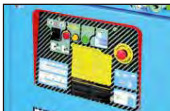
Visera de protección antigolpes y salpicaduras.
