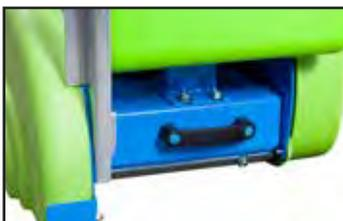
Asa delantera para la elevación manual.
