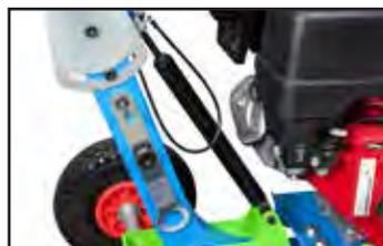
Sistema de elevación mediante amortiguador de gas.
